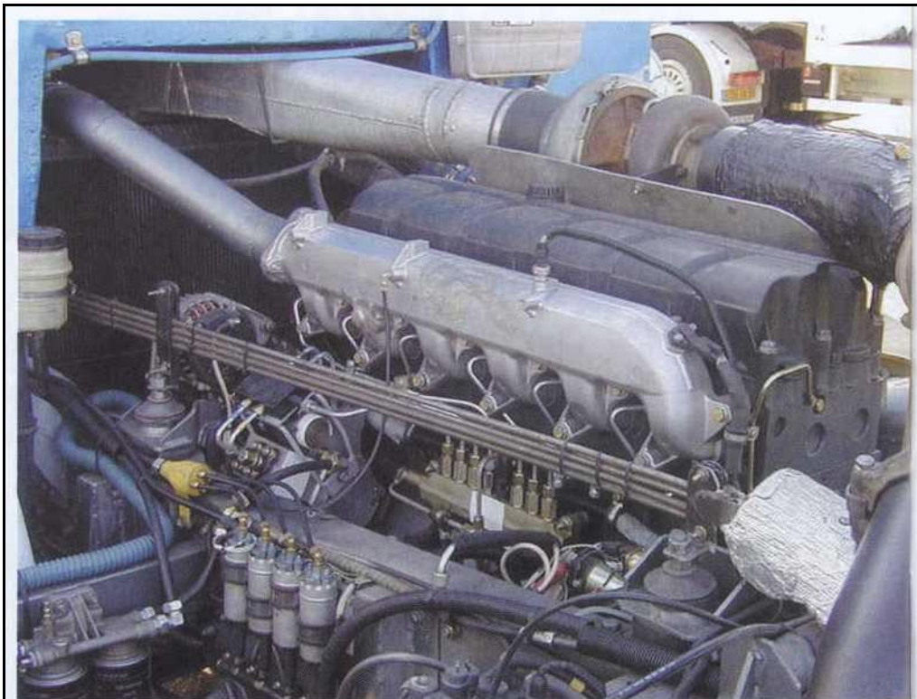
L'équipe française Aravi va courir pour la première fois avec le moteur 420 dCi de Renault. Celui-ci possède une injection par common rail, une première dans les courses de camions.
